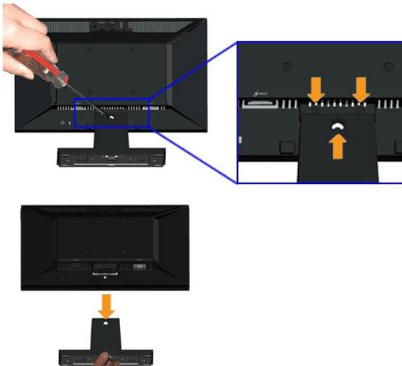
So entfernen Sie die Montagevorrichtung vom Monitor:
